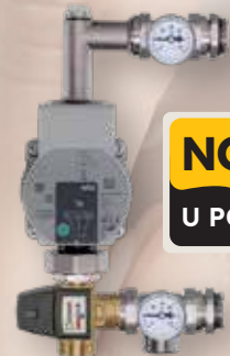
GRUPA INOX ZA RAZDJ. POD.GRIJ. 1" S PUMPA WILO 25-60, VENTIL MJEŠA. ESBE KVS3.4 20-50 °C I RUČNOM ODZRA**
